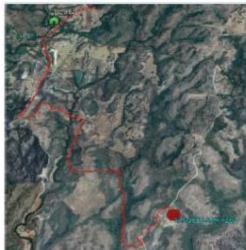
Figura #1. Ruta a Salitral 150mm PVC, por 7,5 km
